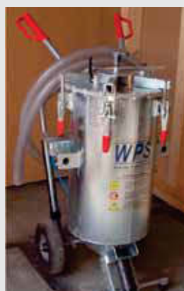
Čerpadlo na maltu pro podmazání prahů stěn.
