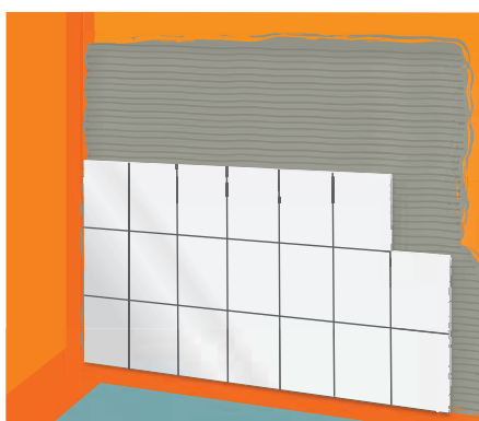
Keramický obklad do tenkého lože z flexibilního lepidla fermacell
